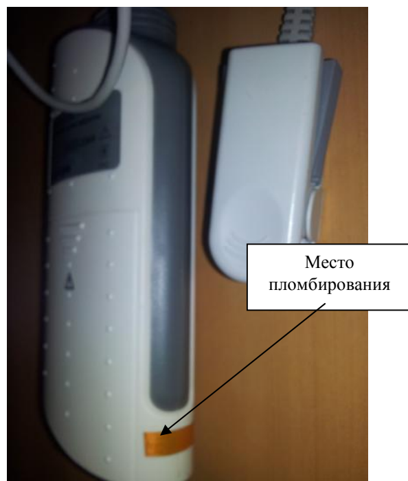
Рисунок 2 - Пульсоксиметр Dixon H100B. Место пломбы.
